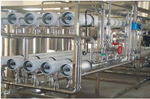
——在染料的生产过程中,应用膜分离技术可以脱除染料中的无机盐,还可以使染料得到浓缩;实践证明,唯有减少染料中的盐分、副染料中间体等才能提高染料的着色强度、才能为添加辅助助剂创造一个稳定的溶剂条件。液体染料则要求几乎完全剔除染料生产中所产生或外加的无机盐,以保证其产品的稳定性与溶解度。膜分离技术作为染料后加工的重要技术手段,在提高染料品质、实现清洁生产工艺上的巨大作用已得到广泛的重视与应用。
